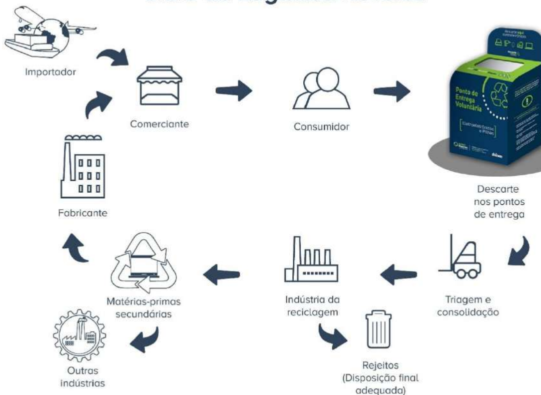
Figura 8 - Ciclo da logística reversa de eletroeletrônicos e pilhas - Green Eletron Ciclo da Logística Reversa
