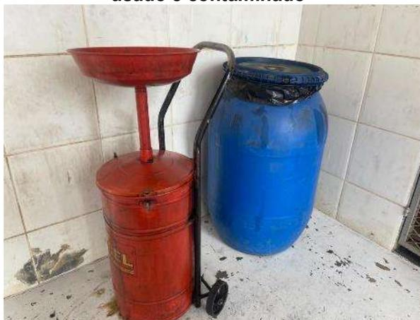
**Figura 148: Local de acumulação de óleo usado e contaminado**
